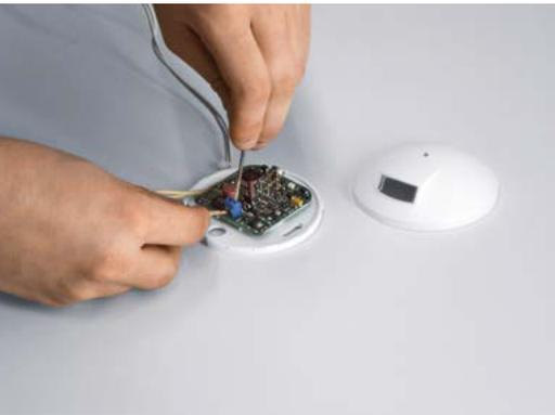
Nun werden die passenden Sensoren und Bediengeräte am Control-In des DIMLITE Basismoduls angeschlossen. Ein zusätzliches Gerät im Schaltschrank ist nicht notwendig, sondern ...
