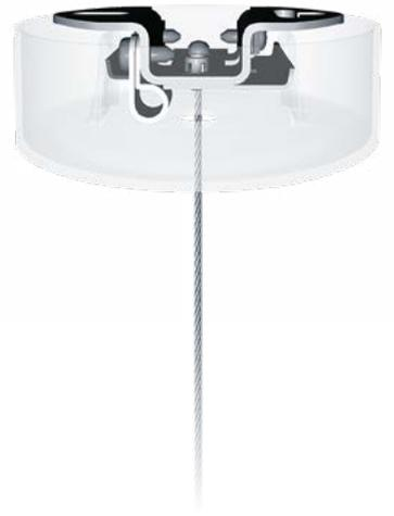
**Baldachin** An der Decke installieren und einfach nivellieren: Der Schraubflansch mit großem Langloch gleicht Maß- und Winkeltoleranzen aus. Bei den Bohrlöchern lassen sich Ungenauigkeiten bis zu 20 mm kompensieren.
