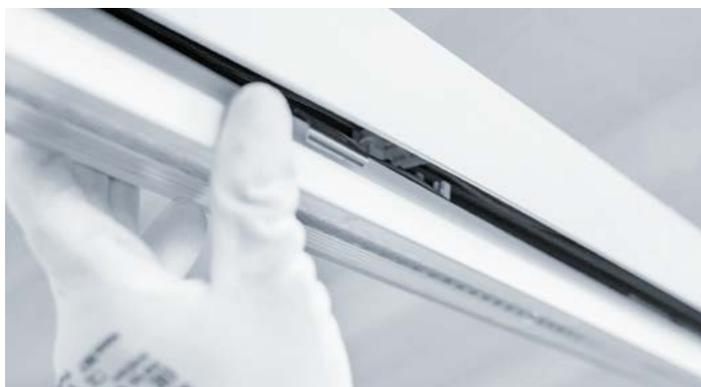
5 Lichtbalken zur elektrischen und mechanischen Verbindung entsprechend der Buchsenabstände positionieren. Das Einrasten in die Tragschiene wird durch ein hörbares „Clix“ bestätigt.
