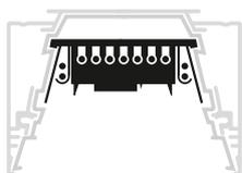
Mit vier verschiedenen Ausführungen ist auch die Durchgangsverdrahtung auf Vielseitigkeit programmiert: Sowohl die 7-polige als auch die 11-polige Ausführung sind – abgestimmt auf die Längen der TRINOS LED-Balken – mit vormontierten Buchsen in einem Abstand von 1,5 und 2 Meter erhältlich.
