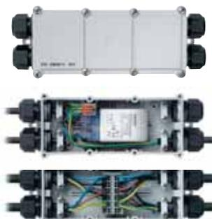
Le boîtier universel IP67 s'utilise avec le petit PASO II S dans les environnements humides ou en extérieur. Il offre un abri sûr pour les appareillages externes. Les câbles adéquats d'un diamètre de 0,8 à 2,5 mm peuvent être posés en câblage traversant ou en câblage en croix. Le boîtier offre également une protection suffisante pour les transfo halogènes et les convertisseurs LED.
