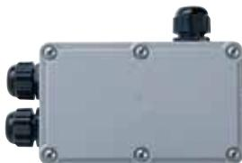
Ce petit boîtier de connexion IP67 permet le branchement étanche à l'eau sous pression d'un maximum de trois câbles adéquats (H07RNF, etc.) pour le câblage traversant à l'extérieur du luminaire. Il peut être utilisé à la place d'un ruban adhésif auto-soudant ou d'un manchon soudé.
